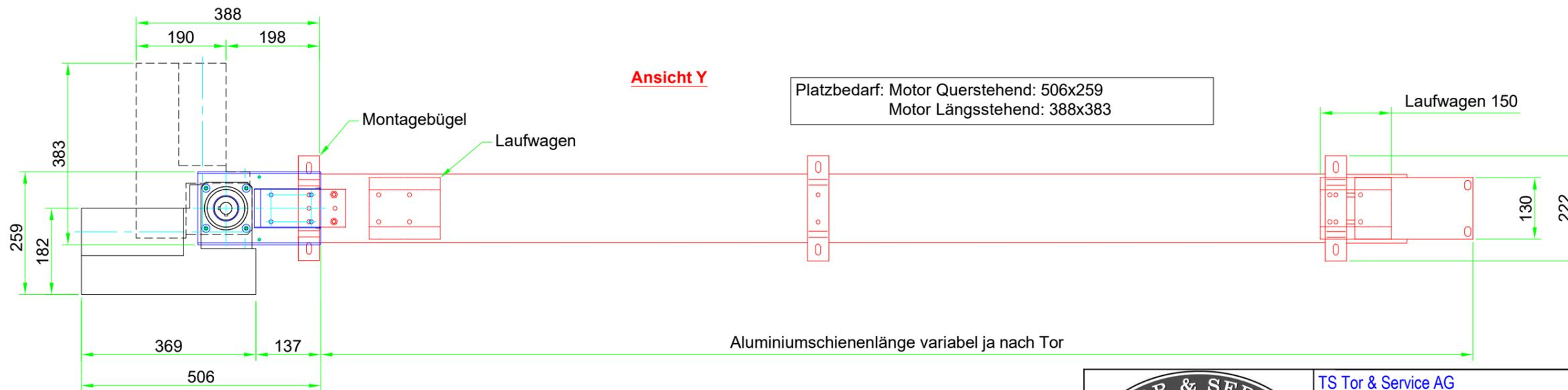
Platzbedarf: Motor Querstehend: 506x259
