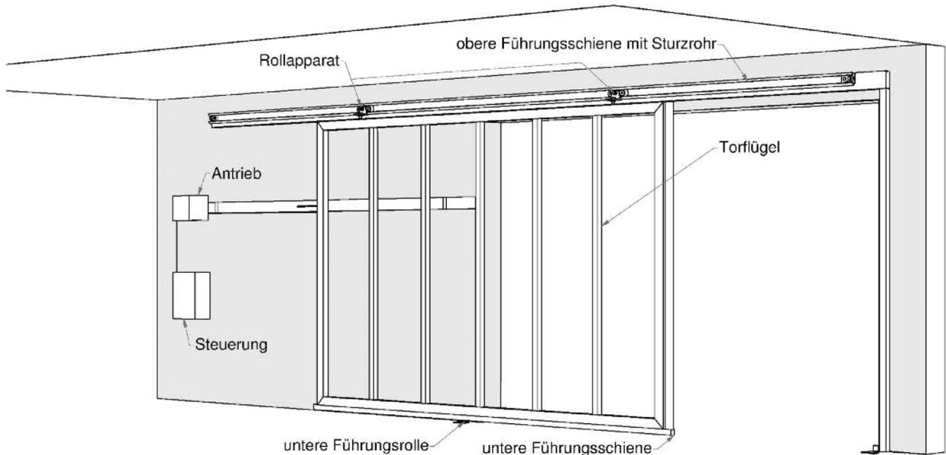
Das Schiebetor zeichnet sich durch eine lange Lebensdauer bei geringen Betriebskosten aus. Es werden keine Federn oder Trageseile benötigt, die dem Verschleiß unterliegen. Auch für den Autofahrer ist sofort erkennbar, wann die Öffnung zur Durchfahrt frei ist. Das minimiert die Gefahr von Anfahrtschäden.
