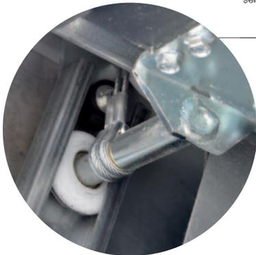
Zur Sicherheit hat das Tor doppelte Tragseile. Für eine lange Lebensdauer sind die Laufrollen kugelgelagert
