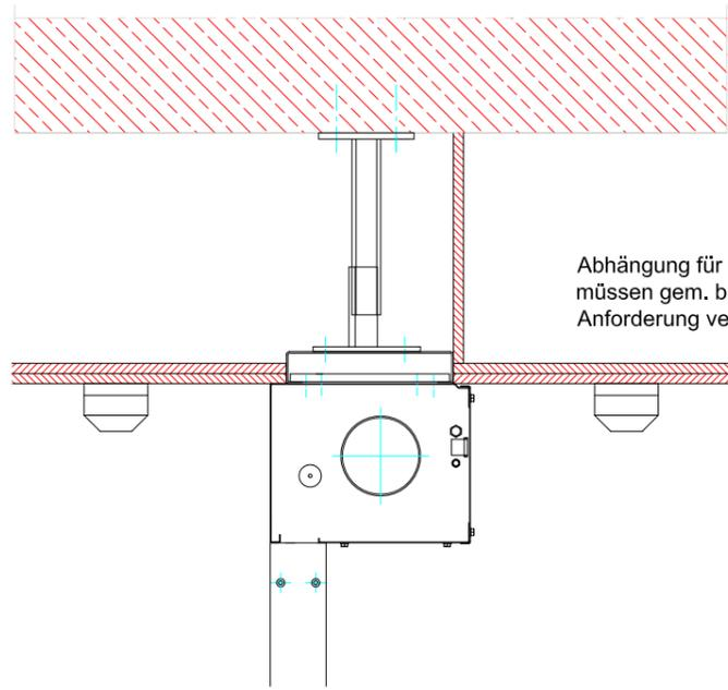
Abhängung für Feuerschutzabschlüsse (TFF) müssen gem. brandschutztechnischer Anforderung verkleidet werden!
