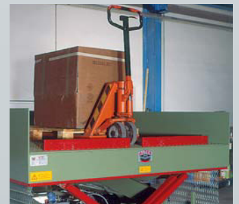
Mechanische Abfallsicherung, verhindert das Abstürzen der Güter.
