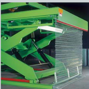
Unterlaufschutz aus Welldrahtgitter in verzinkter Ausführung.
