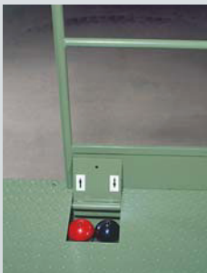
Fußschalter, zum Heben und Senken, in die Plattform integriert.
