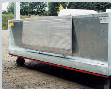
Ladeklappe aus Aluminium, über die gesamte Länge verschiebbar.
