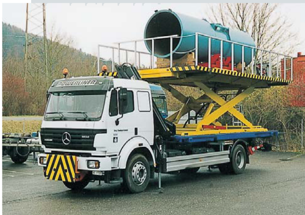
Hebebühne zur Montage von Lüftungsventilatoren in Autobahntunneln.
