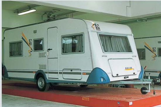
Versenkbare Hubtischplattform ermöglicht das Arbeiten am Dachbereich von Wohnwagen und Wohnmobilen (mit integriertem KfZ-Grubenheber).
