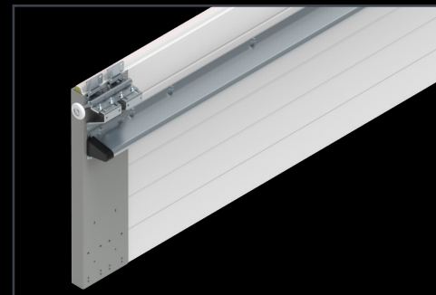
Doppelte Endkappen + Seitenscharniere mit Versteifungsprofil 75 mm (ab 6000 mm)
