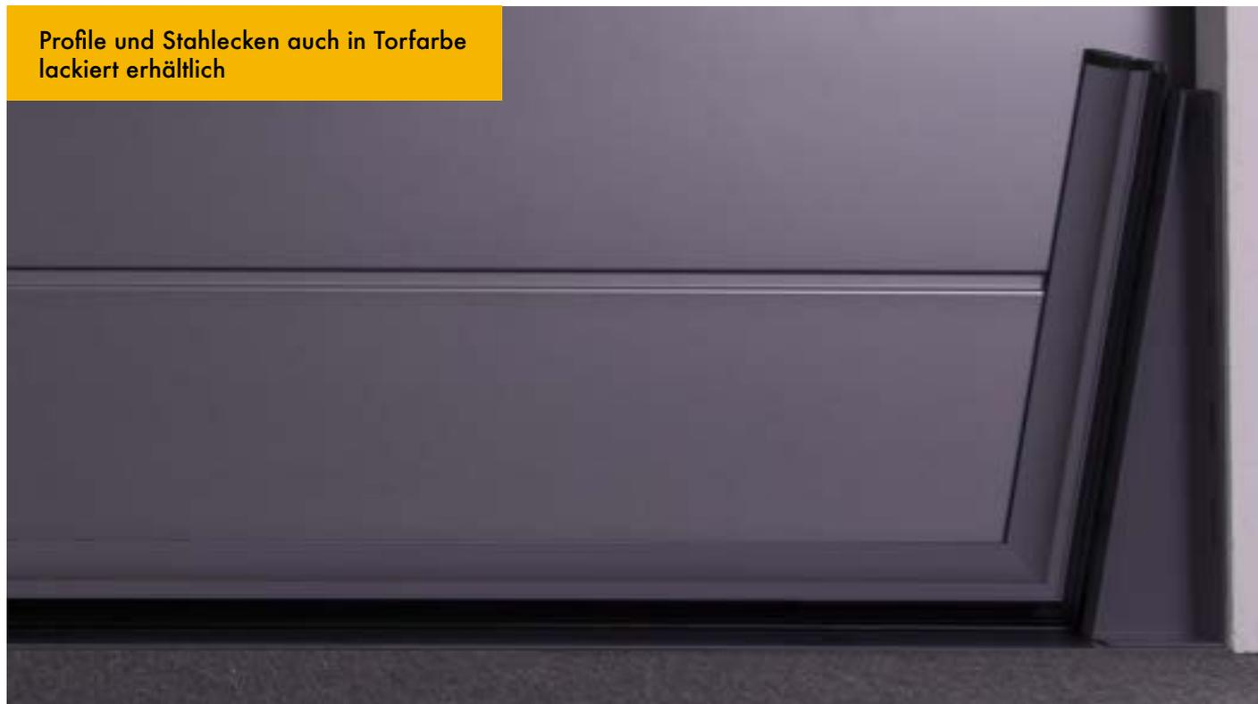
Die links und rechts in der Laibung montierten pulverbeschichteten Stahlecken sorgen für einen optimalen Anpressdruck, so dass die speziell für dieses Tor entwickelte Silikondichtung perfekt schließt. Das optional erhältliche Bodenblech aus wahlweise Edelstahl oder eloxiertem Aluminium garantiert auf der Torunterseite eine absolut ebene Dichtfläche. Die eleganten Aluminiumprofile und Stahlecken sind gegen Aufpreis auch in Torfarbe lackiert erhältlich.
